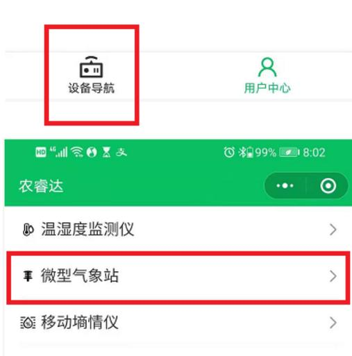
完成设备绑定后，点击页面下方“设备导航”按钮进入主页面，如上图所示。选择“微型气象站”标签即可查看到所绑定的设备。
